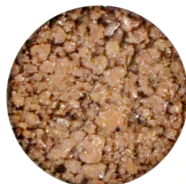
ブラウン 脱色アスファルト
